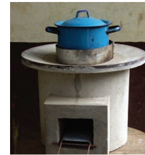
Una faldita se usa para maximizar la transferencia de calor de la cocina a la olla.
